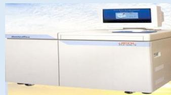
Figure 1- Appareil de chromatographie échangeuse d'ions
