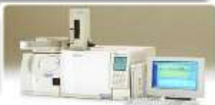
Figure 2: Appareil de chromatographie liquide couplée à la spectrométrie de masse en tandem
